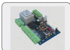
Scheda di controllo: Intel 80C51 MCU, silicio controllato Parametro del motore
